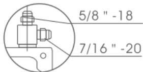
2. 然后检查进气口连接处及所用管道是否密封可靠，不得有渗漏现象；
