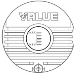
②打开电源开关泵开始运转，运转大约1分钟后，检查油窗内的油位，油位太低需关机加油，最后旋回加油塞；
