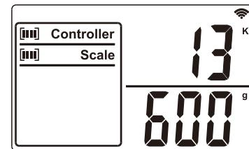
3)、按下加注键“**[1]**”，液晶屏上出现加注功能指示符，然后输入要加注的净重量数值，再按确定键“**[2]**”后，此时显示的是加注的净重量，即钢瓶向系统里加注的净重量。例如：要加注2Kg制冷剂，先按加注键“**[1]**”，然后按照液晶屏上的数字闪烁，依次输入“0-0-2”数字键，再按确定键“**[2]**”即可，显示如下：
