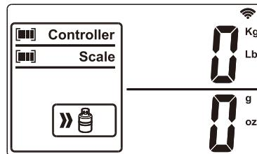
4)、进入回收模式后，回收指示符“
