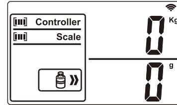
4)、进入加注模式后，加注指示符“
