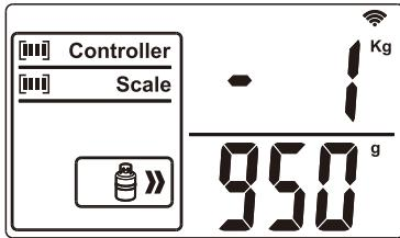
5)、当显示的加注量达到所设定的加注量时，加注完成，手动终止系统加注，按退出键“
